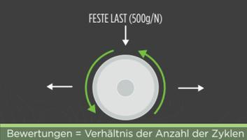
Beim Coupe-Test wird gemessen, wie viele Zyklen benötigt werden, um einen Musterhandschuh vs. ein Referenzmaterial mit einer kreisförmigen Klinge, die sich vor und zurück bewegt, unter einer festen Belastung von 500 g durchzuschneiden.
