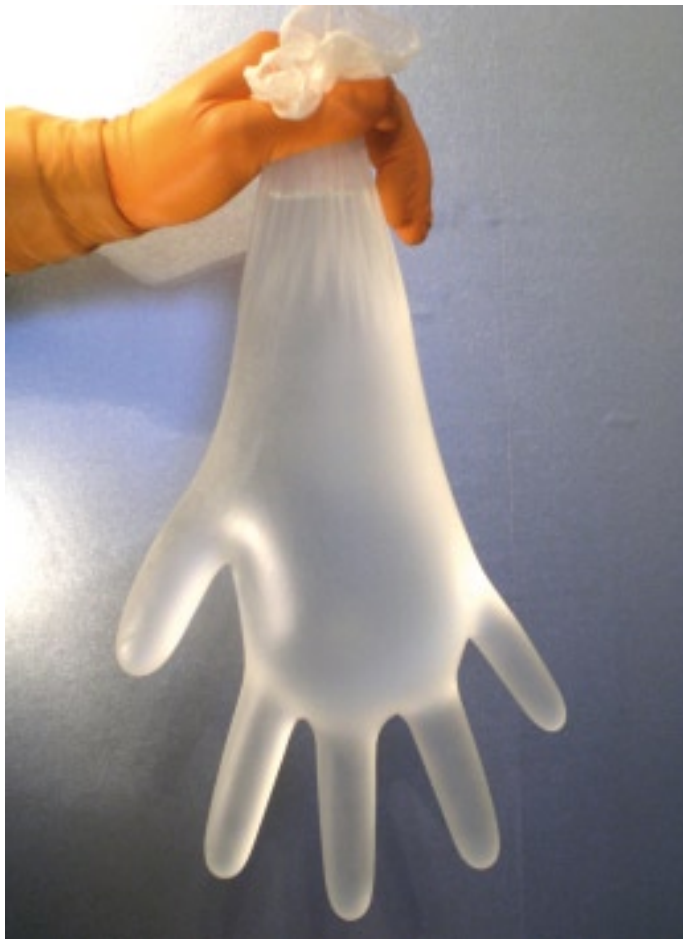
Abb. 1: Vinyl-HS mit 1.000 ml Wasser gefüllt – gemäß EN455-1:2000 – „AQL-Test“.
