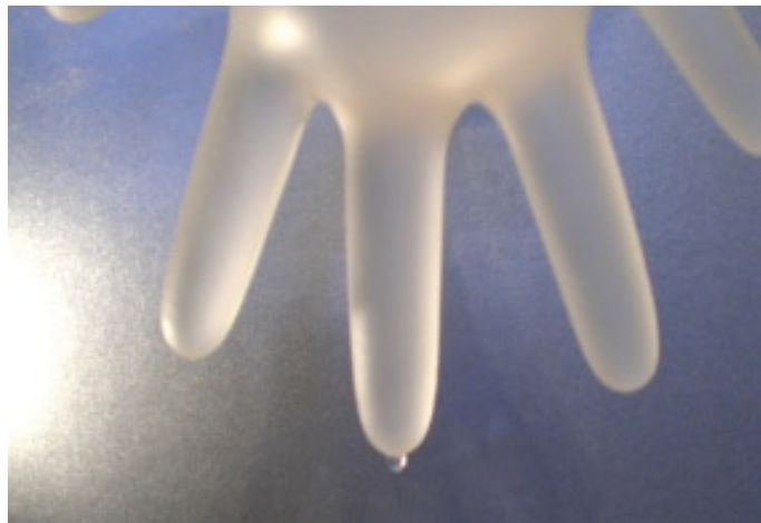
Abb. 2: Die Nahaufnahme zeigt deutlich den Wasseraustritt an der Spitze des Mittelfingers – Barriere-Funktion sehr in Frage gestellt
