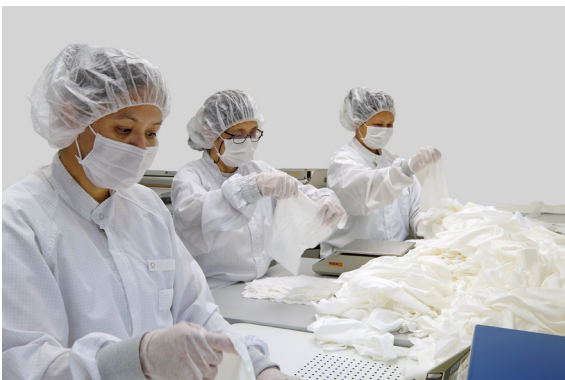
unsere Sichtprüfung und Verpackung im ISO 5-Reinraum
