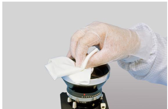
Beispiel: Reinigung optischer Bauteile
