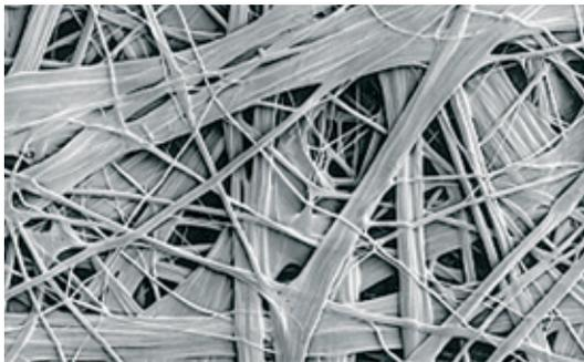
Abbildung 3. Robuste, nicht-gewebte Materialstruktur von Tyvek® (Polyethylen mit hoher Dichte) 1:500 Quelle: DuPont.
